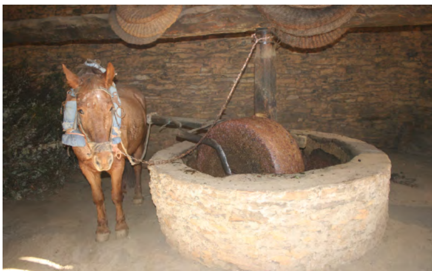
Fig. 12. Conjunto de molturación en el molino oleario de Latedo (Zamora). Autoría: Eugenio Monesma.
