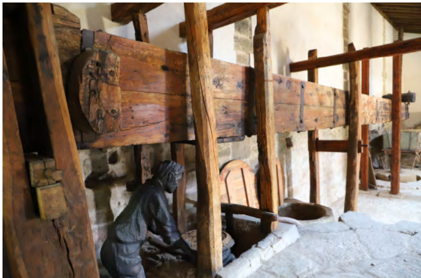
Fig. 1. Prensa de viga del molino aceitero de El Viñedo, en Loporzano. Autoría: Eugenio Monesma.
